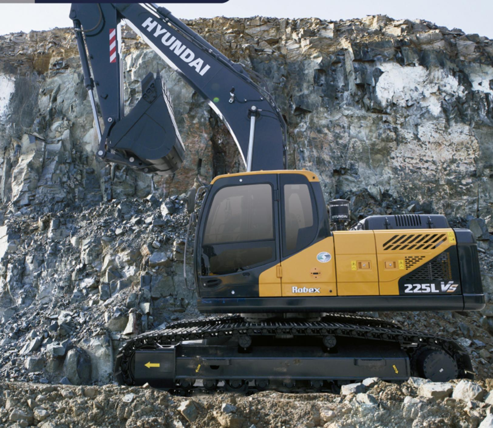
Potência do motor a diesel: 125kW(167HP)/1,900rpm | Peso operacional: 22,570kg | Volume da caçamba: 1,20m<sup>3</sup>
