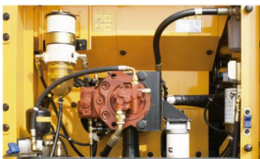
SUBSTITUIÇÃO DO FILTRO DO SISTEMA HIDRÁULICO COM INTERVALO ESTENDIDO DE 1.000H
