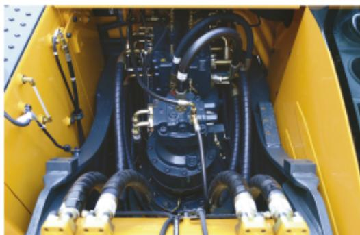
BLOCO DE COMANDO COM CONTROLE DE FLUXO DAS BOMBAS HIDRÁULICAS PRINCIPAIS
